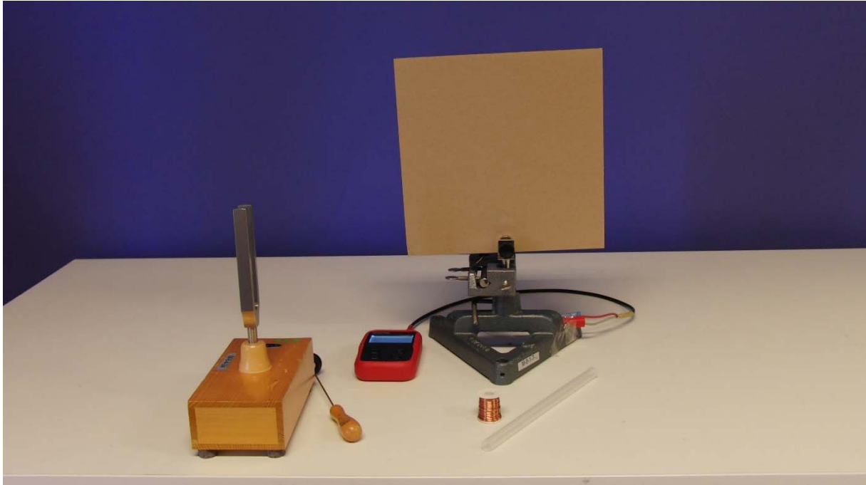
Wellpappenmikrofon von vorn (dabei Kupferdraht und Kunststoffrohr)
